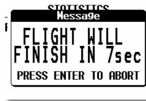
Falls Sie ENTER drücken, bevor die Zeit abgelaufen ist, bleibt der Flug aktiv, bis das Gerät ausgeschaltet wird. Wenn Sie die Zeit ablaufen lassen, erscheint eine weitere Meldung, die besagt, daß der Sicherheitsalgorithmus jetzt berechnet wird.
