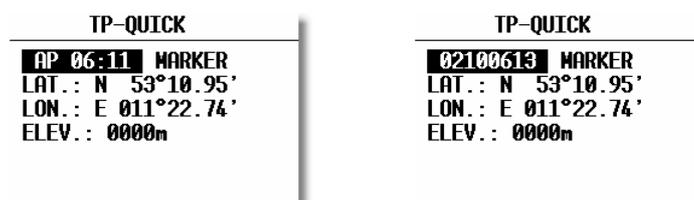
Rechts ist die Benennung nach Datum und Uhrzeit (z.B. 02 10 06:13) zu sehen und links als AP mit Uhrzeit (siehe SETUP nach Passwort Kapitel TP).
