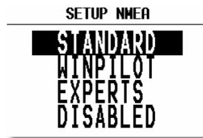
Nach Bestätigung des gewünschten Feldes mit ENTER werden die Datensätze kurz angezeigt. EXPERTS erlaubt eine völlig freie Konfiguration der NMEA-Datensätze
